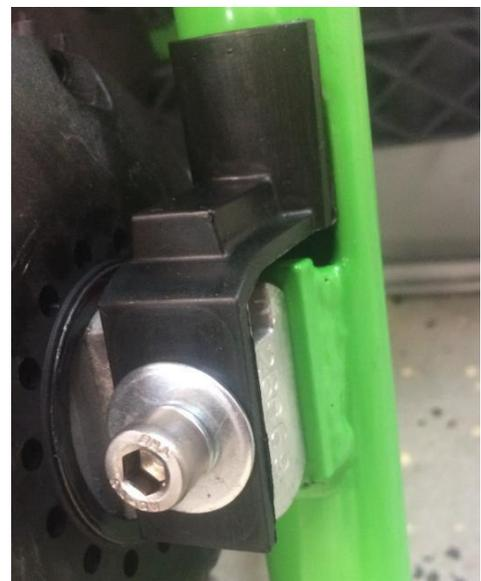
Schrauben an der Einheit lösen, M8x45.
